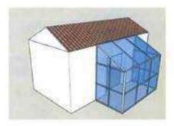
La serra incorporata o a "loggia" condivide con l'edificio tre delle quattro superfici perimetrali e ha la copertura opaca.
