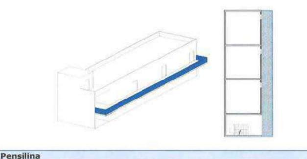
Elemento edilizio di copertura posto in aggetto alle pareti perimetrali esterne di un edificio e priva di montanti verticali di sostegno.
