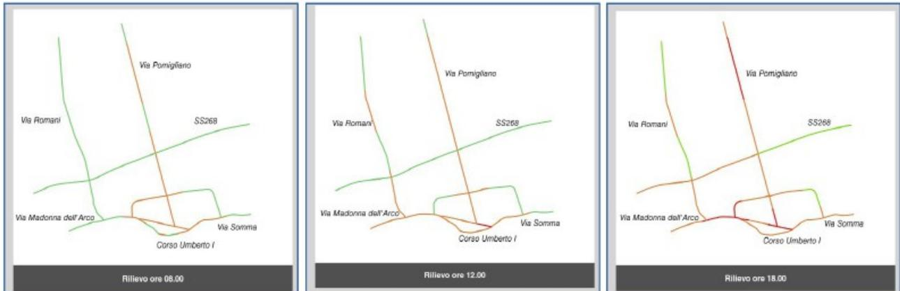
Figura 21. Rilievo del traffico veicolare sulle principali arterie stradali di Sant'Anastasia. In verde: traffico veicolare veloce. In arancio: traffico veicolare lento. In rosso: traffico veicolare molto lento.
