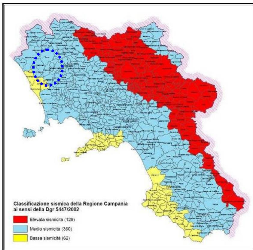
La pericolosità sismica, intesa in senso probabilistico, è lo scuotimento del suolo atteso in un dato sito con una certa probabilità di eccedenza in un dato intervallo di tempo, ovvero la probabilità che un certo valore di scuotimento si verifichi in un dato intervallo di tempo.
