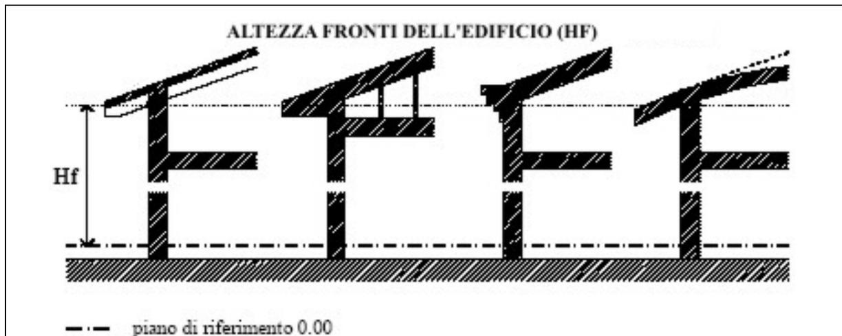
Nel caso la pendenza della falda superi il 35% o la larghezza del cornicione superi m.1,20 dalla parete verticale, l'altezza va misurata ai due terzi della lunghezza della relativa falda, a partire dalla linea di gronda.
